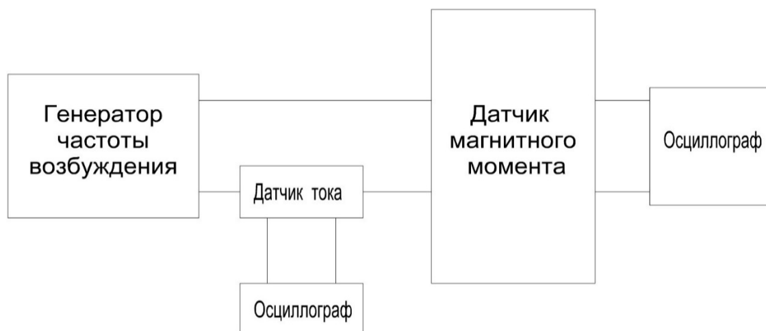
Рис. 1.1. Функциональная схема лабораторного макета для выявления влияния материала сердечника на эффективность работы датчиков магнитного момента.
