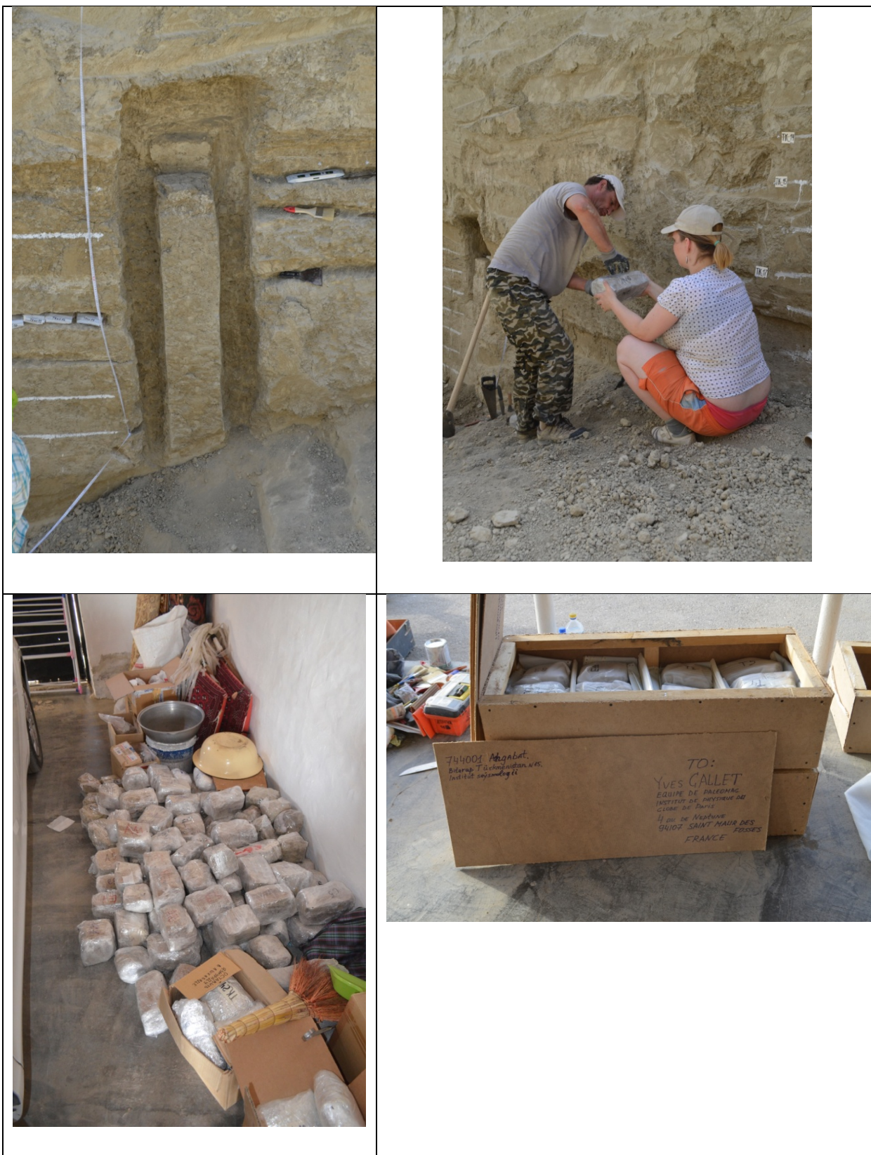
Рис. 5.4. Пробы, отобранные из разреза такырных отложений, предназначенные для проведения различных анализов.
