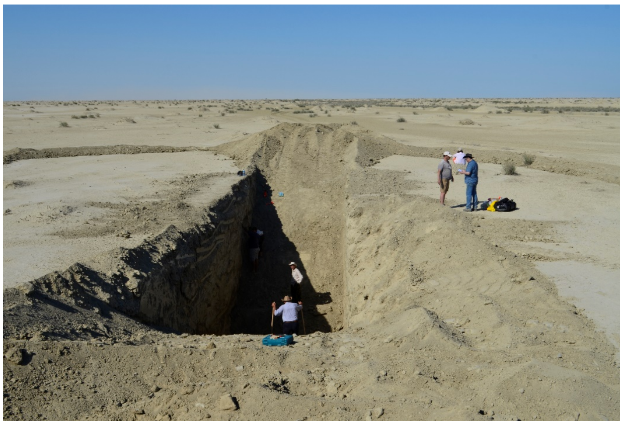
Рис. 5.3. Раскопы, заложенные для изучения разреза такырных отложений и отбора.
