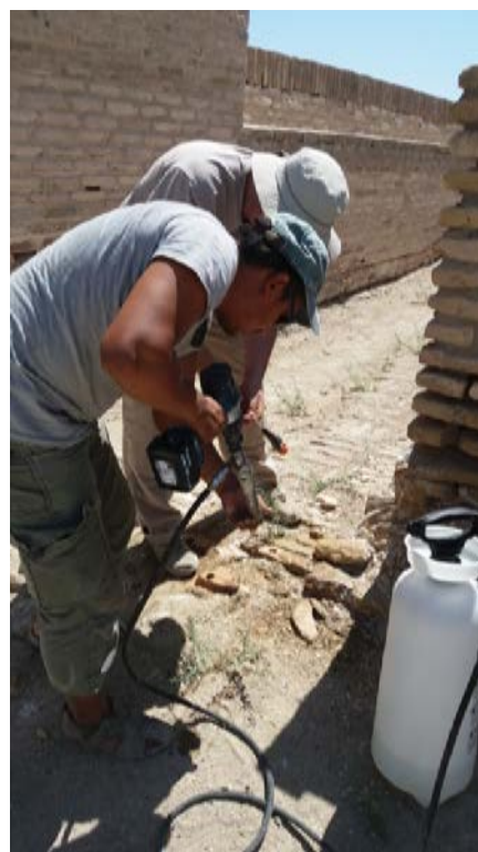
Отбор образцов для археомагнитных исследований из архитектурных памятников г.Бухара
