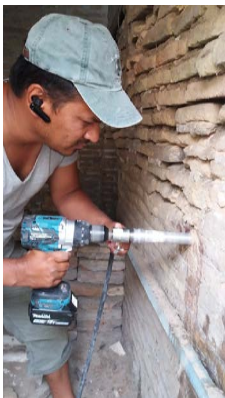
Отбор образцов для археомагнитных исследований из архитектурных памятников г.Бухара
