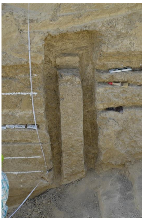
Рисунок 2.4.5. Траншеи, заложенные для отбора образцов во время полевых работ Туркменистане в июне 2016 года: а – траншея, б – штурф для отбора ориентированных блоков пород и уровни, отмеченные для отбора проб на ОСЛ (см. текст)
